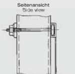
B) unterer Netzhalter für Pfosten mit Lasche und 2 Schrauben
