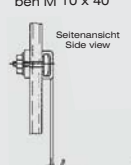
G) unterer Netzhalter für Zwischenstab mit Lasche und 2 Schrauben M 10 x 40
